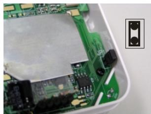
Датчик температуры помещения включен (заложен якорек)
