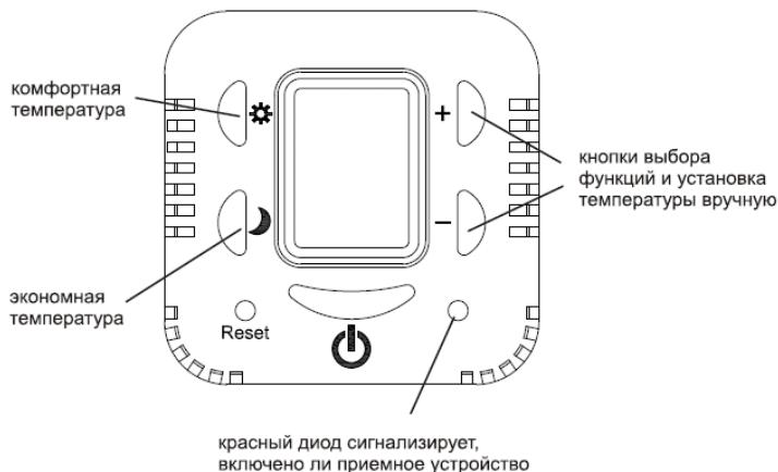
Следует приспособить температуру (комфортную, экономную и ограничения температуры полы) так, чтобы получить идеальную температуру, гарантирующую Вам лучшие условия и уют в Вашем доме и помещении.
